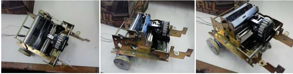
Figura 4: Confeção de um “robô” com material reaproveitado em desmontes
